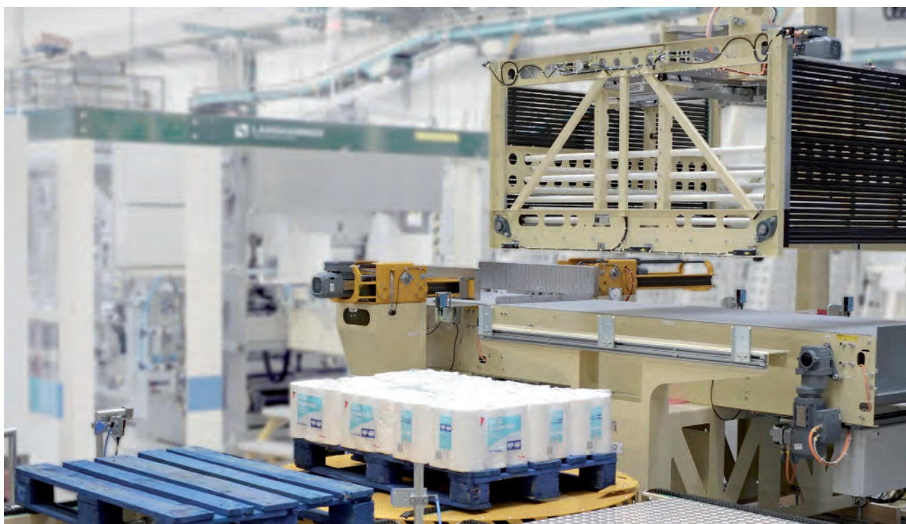
Palettier-Roboter PRO04: Produktgreifer GR42 wartet über Pick-Position
